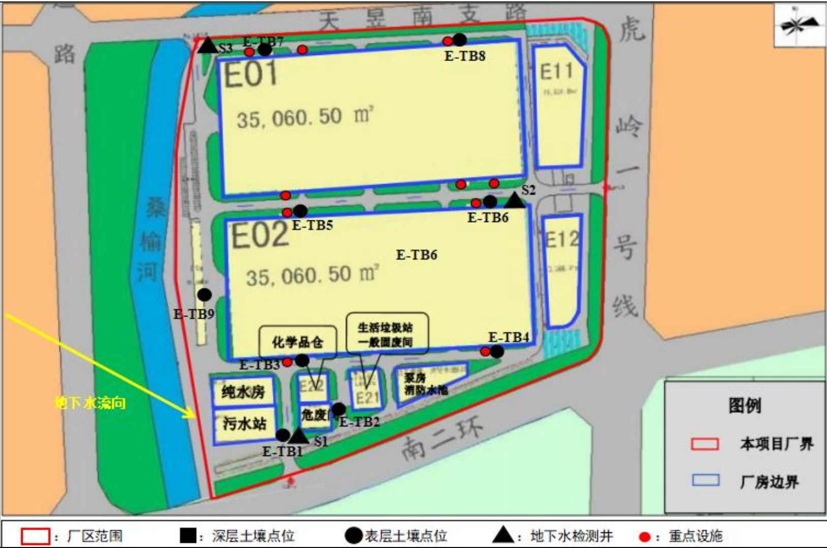
图 6-1 厂区土壤和地下水点位布设图
